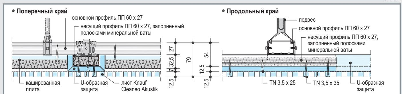
Наружный потолок П127 под огнезащитным покрытием, например, потолком П112
