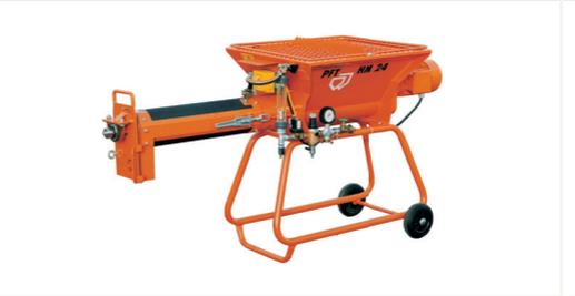
Компактный проточный миксер **HM24** может наполняться как из мешков, так и из силоса, и служит для смешивания сухих смесей с водой в заданной пропорции. При оснащении миксера датчиком наполнения, он может работать в автоматическом режиме – включаясь и выключаясь в зависимости от наличия раствора в баке, тележке или приемном бункере транспортного насоса. Электропитание миксеров осуществляется от сети 400 В.
