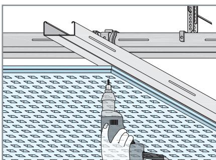
Плиты крепятся к каркасу из потолочного профиля ПП 60/27 при помощи шурупов SN 3,5 x 30, располагаемых с шагом не более 170 мм. При креплении шурупами плиты следует плотно прижимать к несущим профилям. Монтаж плит производится в поперечном направлении относительно несущих профилей. Крепление ведется от угла плиты. Сначала закрепляются плиты со стороны продольной кромки, потом торцевой.
