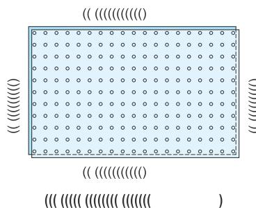
Плиты КНАУФ-Акустика 4ФК имеют фальцевые кромки с четырех сторон. Два кромочных фальца расположены ближе к тыльной стороне плиты, а два других расположены на противоположных кромках ближе к лицевой стороне плиты. Это позволяет выполнять точнуюстыковку плит. Такое соединение дает плотный стык с лицевой стороны, не требующий дополнительного шпаклевания.
