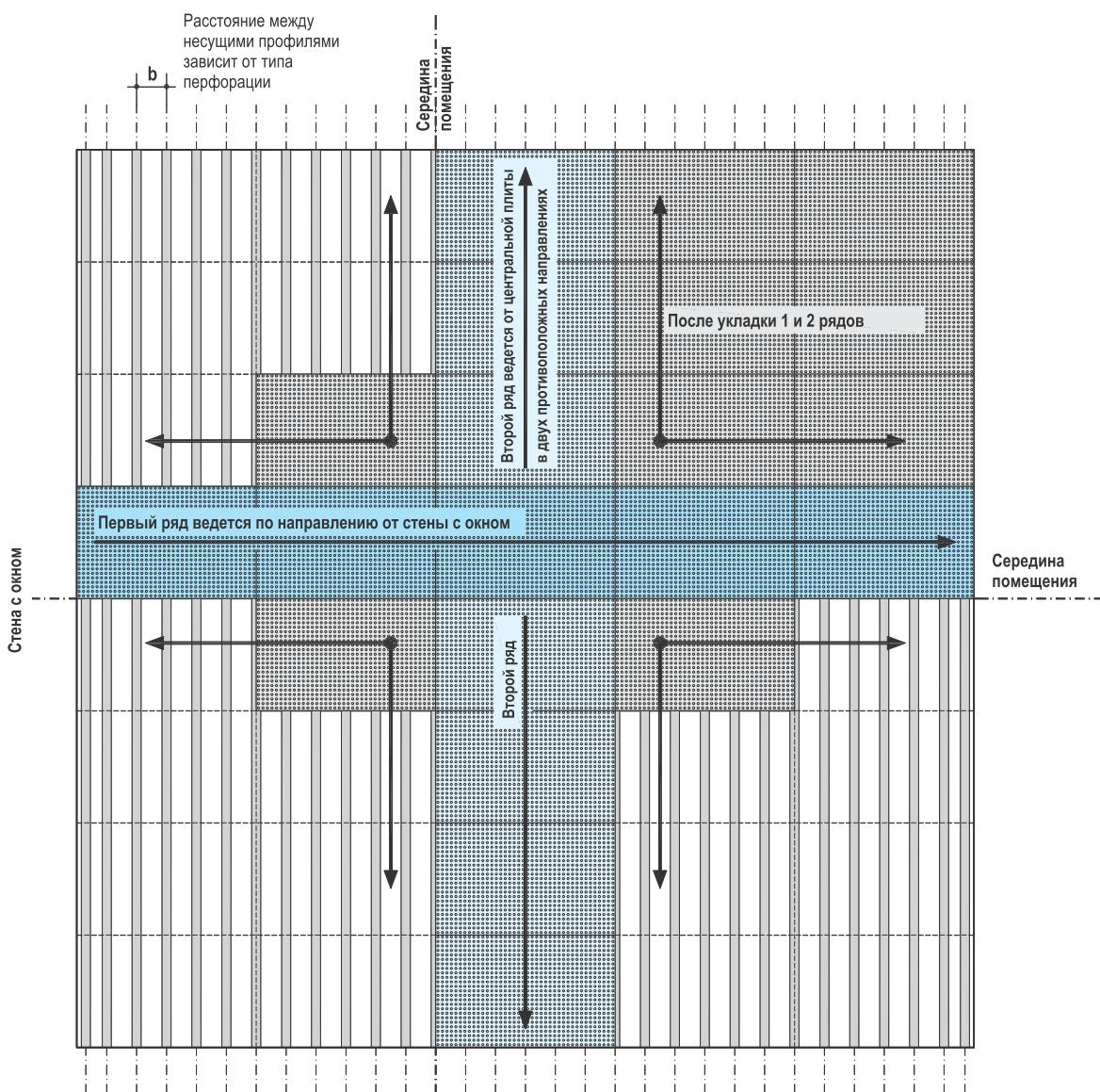
**Примечание.** В каждом конкретном случае нужно разрабатывать собственную схему монтажа каркаса и крепления плит. Конструктивные решения узлов приведены в Техническом листе П 127.
