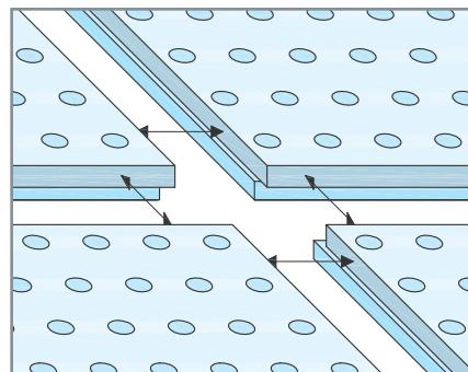
При монтаже плит фальцевая кромка ФК одной плиты, расположенной ближе к лицевой стороне, стыкуется с фальцевой кромкой другой плиты, расположенной ближе к тыльной стороне.
