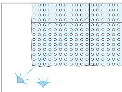
Плиты монтируются так, чтобы ряды перфорации по диагонали, в продольном и по перечнем направлениях не имели смещений (см. схему на стр. 4).
