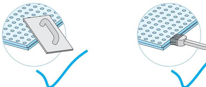
С лицевой стороны плит все кромки имеют небольшой скос и не требуют дополнительного шлифования. Кромки плит грунтуются в заводских условиях.
